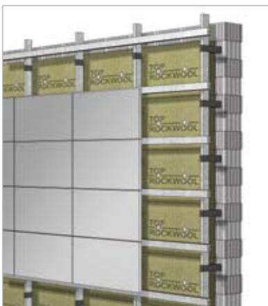
Il paramento esterno caratterizza l'immagine dell'edificio e può essere costituito da differenti materiali: lamiere metalliche, pietra, laterizio, materiali ceramici, laminati plastici, legno, fibrocemento, cemento rinforzato, ecc. Ogni materiale è contraddistinto da diversi
