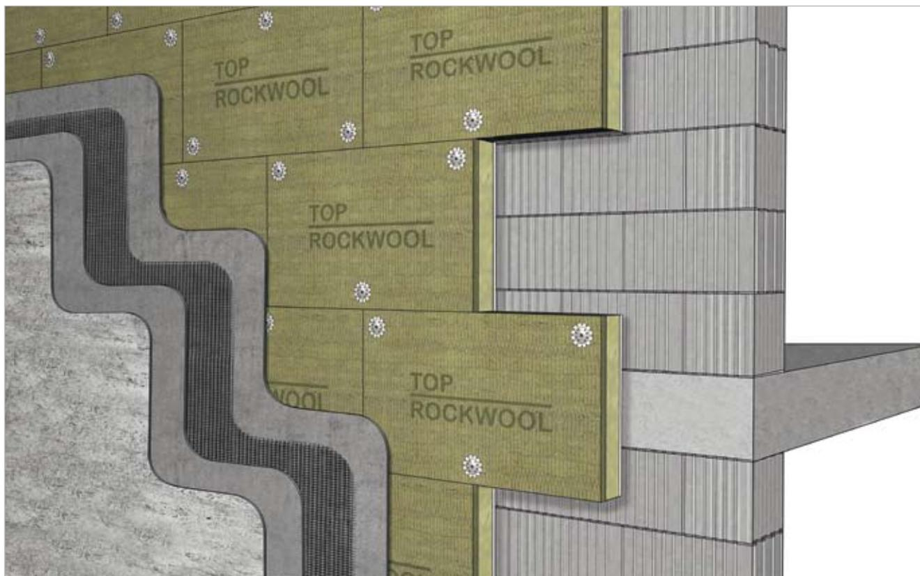
*La soluzione tecnologica consiste in una parete perimetrale con sistema "a cappotto". La parete è isolata termicamente e acusticamente mediante pannelli in lana di roccia ad alta densità (mono densità o a doppia densità) applicati sul lato esterno del paramento murario e fissati ad esso tramite incollaggio e ancoraggio meccanico (con appositi tasselli).*
