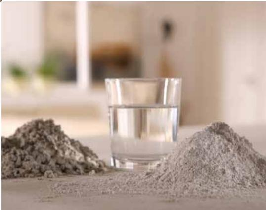
L'obbligo relativo alla genuinità dei prodotti FERMACELL è un aspetto molto importante: per produrre le lastre in gessofibra FERMACELL vengono impiegati esclusivamente materiali naturali. Essi consistono in carta riciclata, gesso ed acqua che, sottoposti ad alta pressione, si compattano fino a formare lastre stabili ed inodori.
