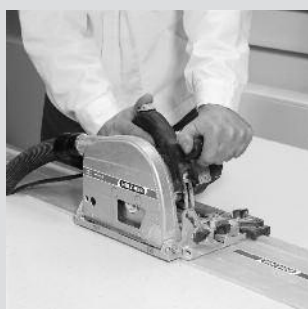
f. Taglio con sega circolare manuale a tuffo con profondità dell'incisione controllata e velocità regolabile.
