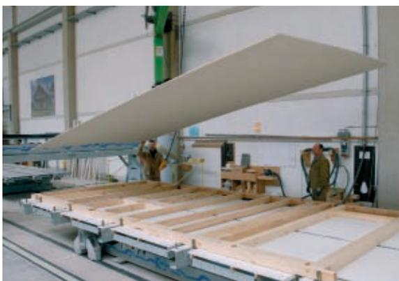
**Prefabbricazione di una parete in legno con pannelli intelaiati rivestiti con lastre di gesso-fibra FERMACELL.**
